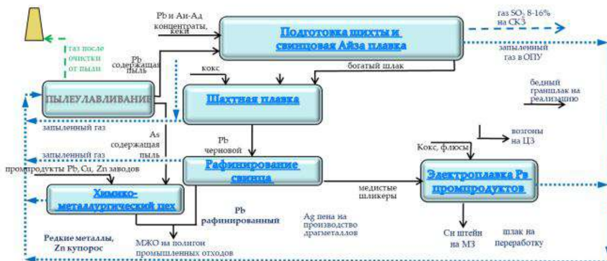
Блок-схема 1.1 Технологическая схема Свинцового завода УКМП
